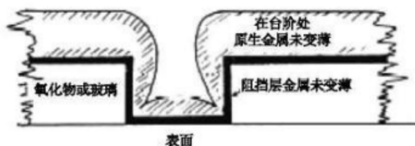
图 24 20%金属层覆盖(包括阻挡金属)
