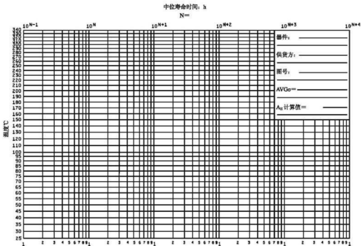
图2 Arrhenius 图 高温工作试验 加速寿命
