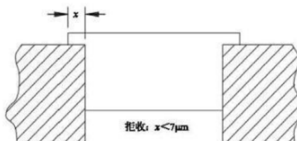
图 17 H 级接触重叠判据
