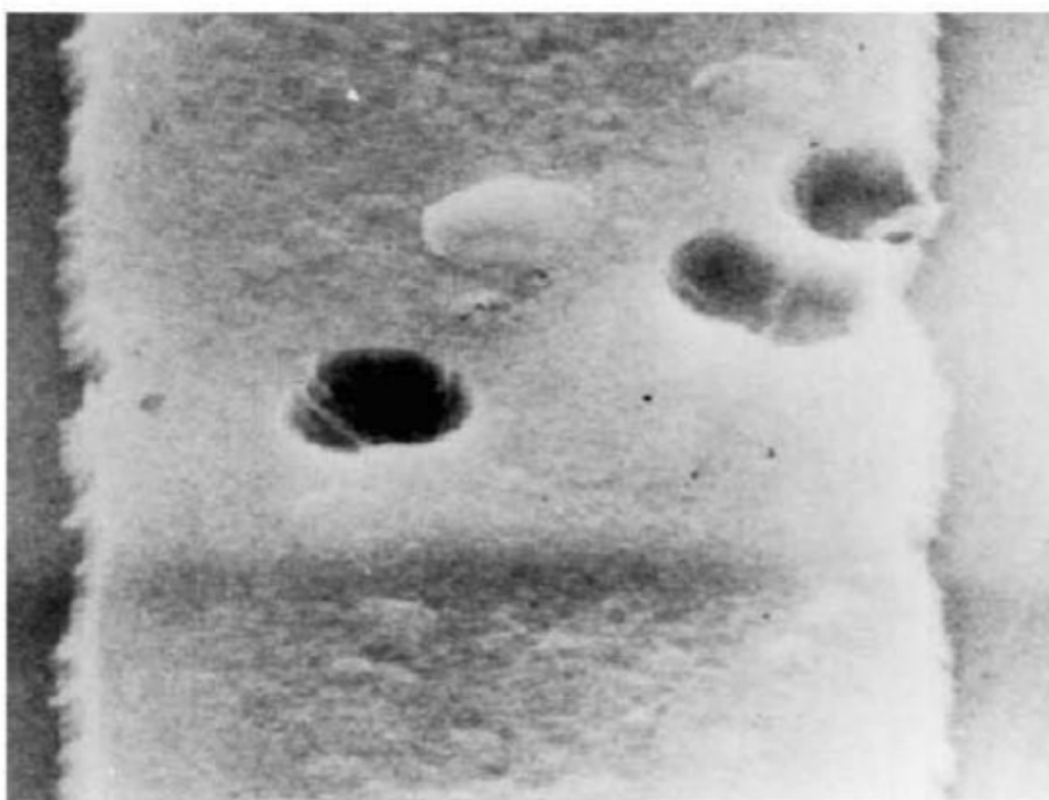
图 20 (5000 倍)一般金属化层中的空洞(拒收)
