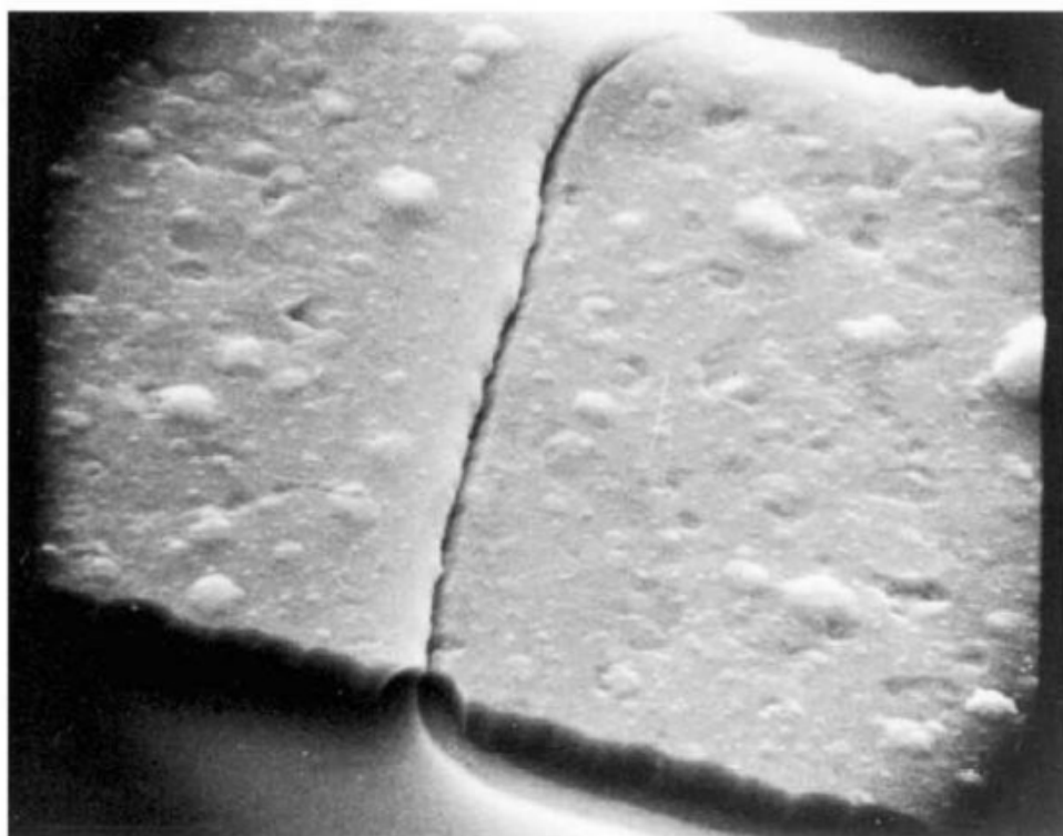
图9 (5000倍)钝化层台阶上的隧道/洞(拒收)
